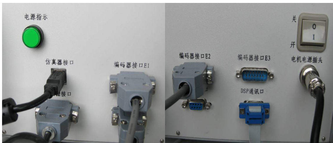
图 3-5 驱动控制箱前面板插接件连接后的示意图
