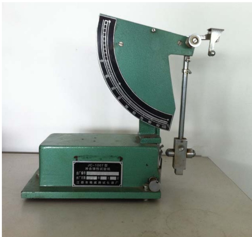
型号为 JC-1007 的弹性试验机
